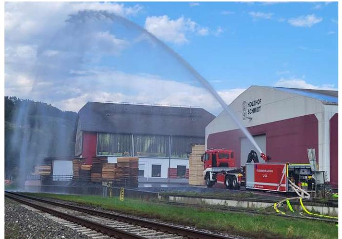
Der Wechselcontainer war mit 8000 Liter Wasserinhalt in Betrieb. Die Wasserversorgung erfolgte über den Pestlingbach mit 4 Tragkraftspritzen, Wasserwerferbetrieb mit einer Literleistung von 4000l/min und Wurfweite von 80m.
